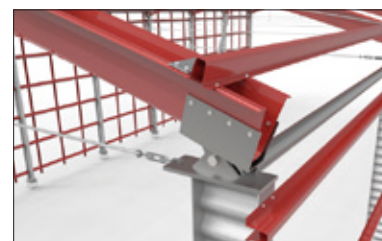
Fixação no Pilar
